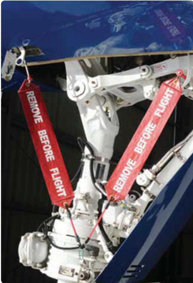
Figura 13-42. Dispositivos de trava do trem de pouso em solo.
