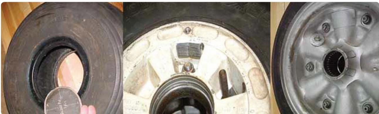
**Figura 13-159.** Um patch de balanceamento de pneus (à esquerda), pesos da roda adesivas (centro), e um peso da roda aparafusado (direita) são usados para equilibrar pneu da aeronave e por instruções do fabricante de rodas.
