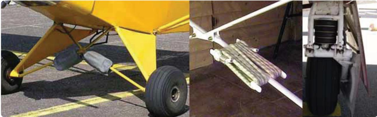
**Figura 13-15.** Piper Cub bungee Cord landing gear transfere a carga da aterrissagem à estrutura da aeronave (esquerda e centro). Rubber, donut-type shock transfer é utilizado em algumas aeronaves Mooney (direita).
