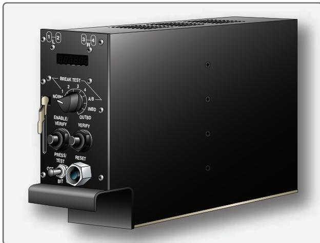
**Figura 13-108.** Um rack montado de controle antiderrapagem de um avião.
