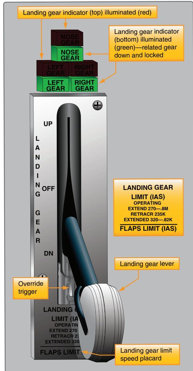
Figura 13-43. Painéis de seletores de trem de pouso com luzes de indicação de posição. No painel Boeing 737 uma luz vermelha se acende acima das luzes verdes para indicar que o equipamento está em trânsito.
