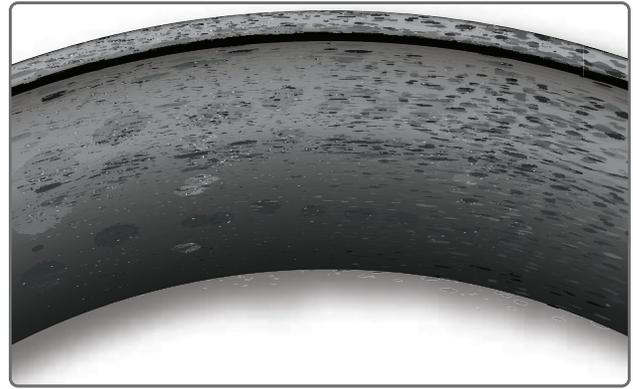
**Figura 13-71.** Nódos negros são causadas por contaminação por partículas finas, possivelmente a partir de uma má vedação ou manutenção indevida do rolamento de limpeza. Ele deixa a superfície menos lisa na capa do rolamento.
