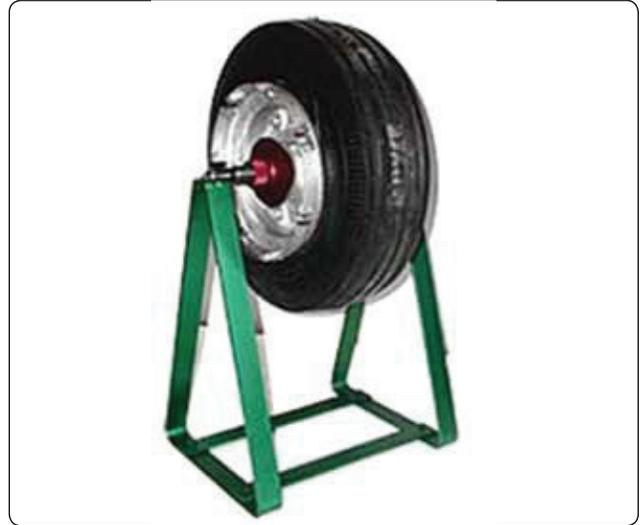
**Figura 13-158.** Um pneu de aeronave típica e a roda numa posição de calibre.
