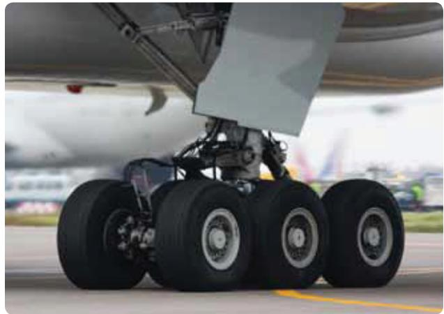
**Figura 13-9.** Trem de pouso principal com triplo truque em um Boeing 777.
