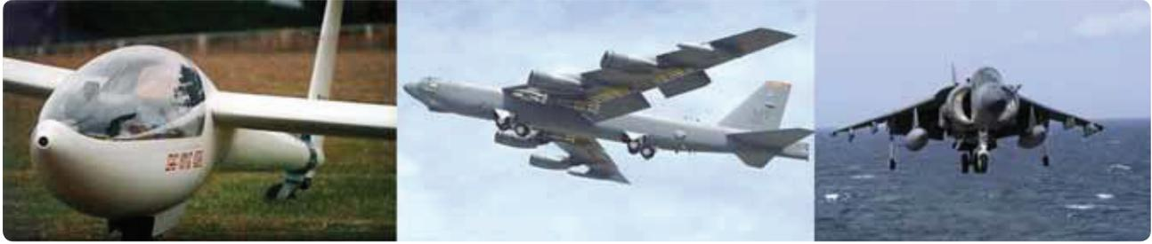
**Figura 13-5.** O trem de pouso tandem ao longo do eixo longitudinal da aeronave permite a utilização de asas flexíveis em planadores (esquerda) e seleciona aeronaves militares como o B-52 (centro). O VTOL Harrier (direita) possui trem de pouso tandem com outrigger-type gear.
