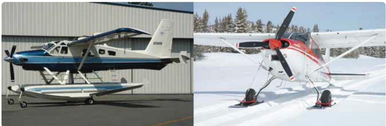
**Figura 13-2.** Aeronave anfíbio com rodas retráteis (esquerda) e aeronave com esquis retráteis (direita).
