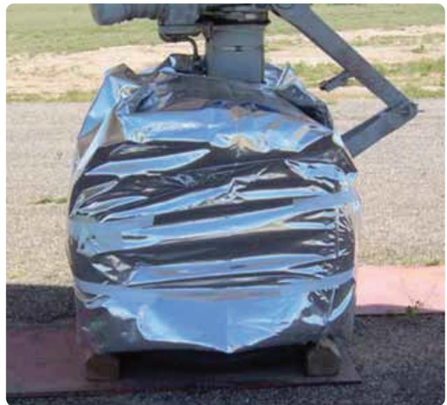
**Figura 13-145.** Cubra os pneus para proteger de substâncias químicas nocivas e dos elementos quando estiver estacionado externamente por longos períodos de tempo.
