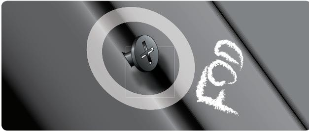
**Figura 13-137.** Marcação da área danificada para permitir maior inspeção.
