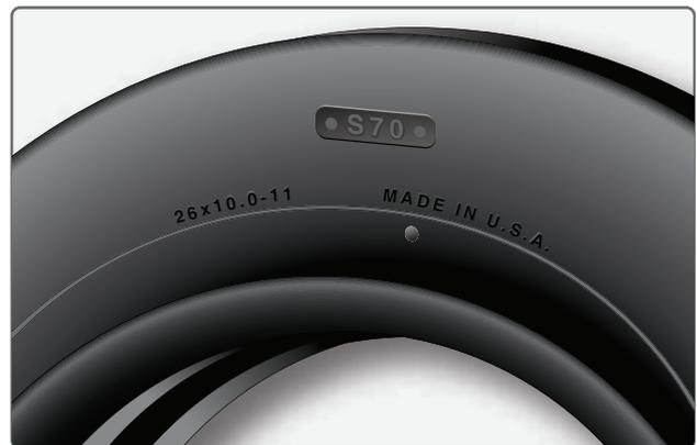
**Figura 13-132.** Uma abertura lateral marcada por um ponto colorido deve ser mantida livre de obstrução para permitir que o ar aprisionado ou nitrogênio escape das lonas da carcaça do pneu.
