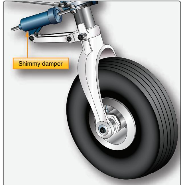
**Figura 13-21.** Um shimmy damper ajuda a controlar as oscilações do trem de pouso do nariz.
