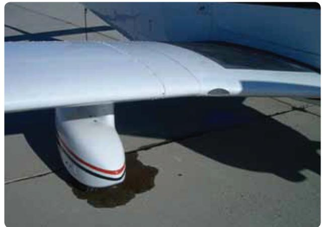
**Figura 13-120.** A causa de todos os vazamentos de freio de aeronaves devem ser investigados, reparados e testados antes de liberar a aeronave para o voo.
