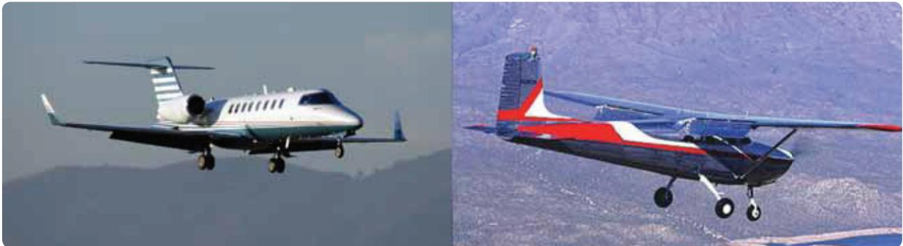
**Figura 13-6.** Trem de pouso triciclo com duas rodas principais em um Learjet (esquerda) e em um Cessna 172, também com trem de pouso triciclo (direita).
