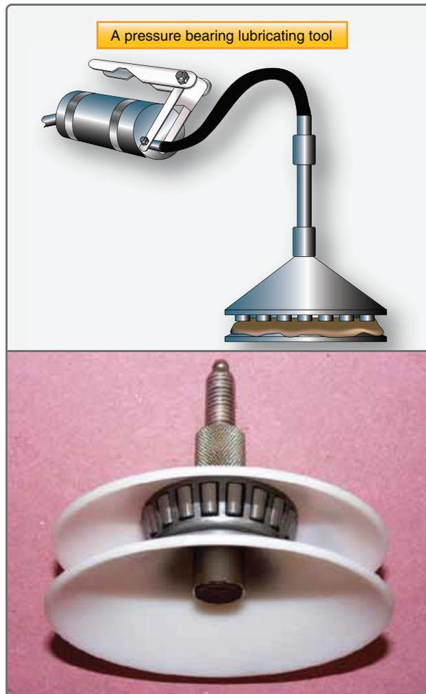
Figura 13-73. Uma ferramenta de lubrificação do rolamento de pressão.
