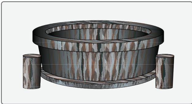
**Figura 13-70.** Decapagem e corrosão é provocado quando a água, e os danos causados pela água, penetra na superfície de tratamento o elemento de rolamento. Ele aparece como uma descoloração avermelhada / marrom.
