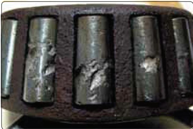
**Figura 13-65.** Descamamento é uma porção lascada da superfície endurecida de um rolamento ou raça.
