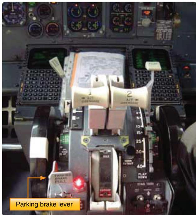
**Figura 13-102.** A alavanca do freio de estacionamento em um Boeing 737 no centro pedestal quadrante do acelerador.
