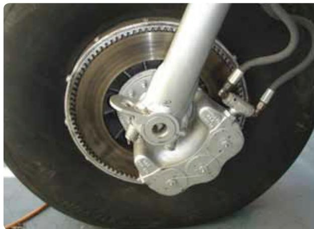
**Figura 13-78.** Um único freio a disco é um disco flutuante, freio com pinça fixa.
