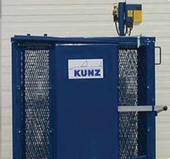
**Figura 13-154.** Gaiolas de inflação modernas foram testadas para resistir a falha catastrófica de um conjunto de pneu e roda durante a inflação. Todos os pneus montados recentemente devem ser inflados na gaiola.
