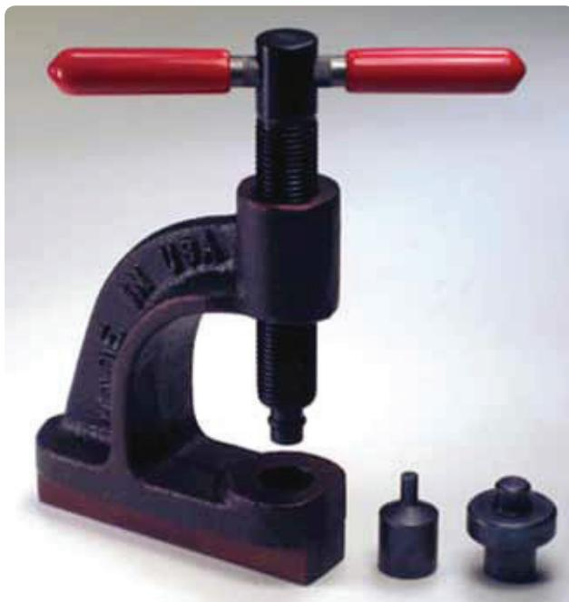
**Figura 13-124.** A ferramenta de configuração de rebite é usada para instalar lonas de freio de Cleveland em placas de pressão de freio e placas traseiras.
