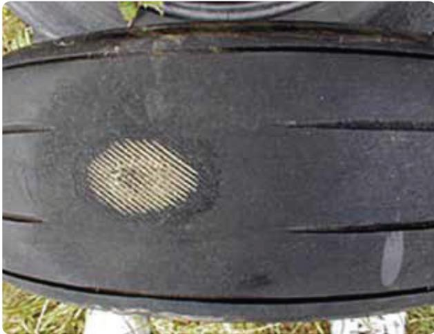
**Figura 13-140.** Aterragem com o freio provoca uma mancha no pneu furado que expõe a banda de rodagem e requer substituição do pneu.
