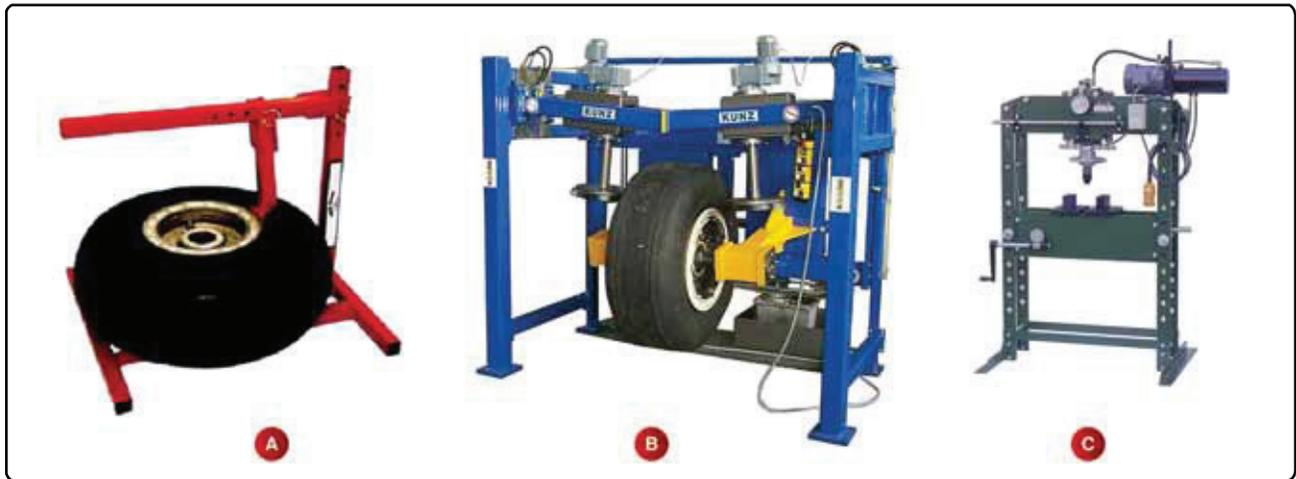
**Figura 13-63.** Rebordos do pneu devem ser quebrados a partir da roda para remover o pneu. A ferramenta de remoção mecânica projetada para romper o cordão é mostrado em (A), uma prensa hidráulica projetado com a capacidade para rodas de aeronave grandes está mostrado em (B) e uma prensa de veio está representada na (C). Todas são ferramentas disponíveis o técnico para esta finalidade.
