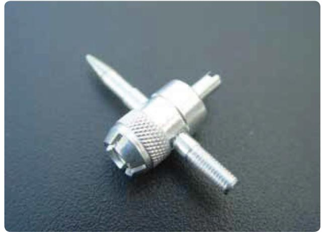
**Figura 13-27.** Esta ferramenta de válvula possui thread chasers internos e externos, uma ferramenta de remoção/instalação de núcleo de válvula notched, e um tapered end para pressionar o núcleo da válvula ou limpar resíduos.
