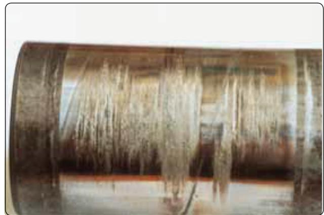
**Figura 13-64.** Gripagem é provocada pelo atrito das superfícies conjugadas. O metal fica tão quente que solda, e a superfície metálica é destruída pois o movimento continua e puxa o metal para além do sentido de movimento.
