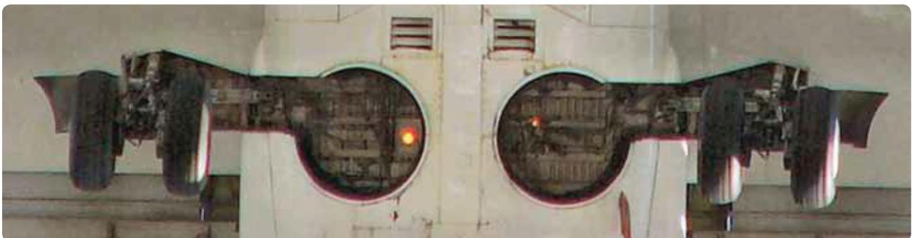
**Figura 13-12.** Trem de pouso retrátil de um Boeing 737 alojado na fuselagem. Painéis fixos no equipamento proporcionam um fluxo de ar suave nas barras. Os conjuntos de rodas mate with seals para oferecer um fluxo aerodinâmico sem portas.
