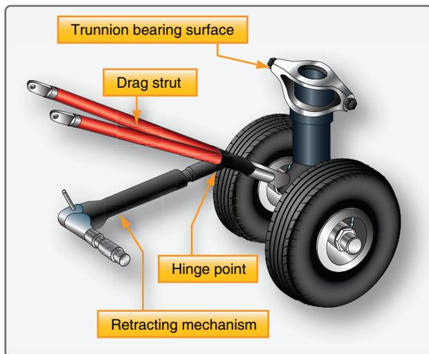
**Figura 13-33.** Uma dobradiça na haste mantém o trunnion e trem de pouso fixo para aterrissagem e operações de solo. Ele se dobra na dobradiça para permitir a retração no equipamento.
