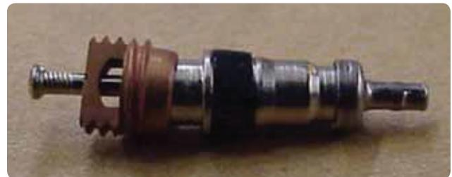
**Figura 13-148.** O núcleo da válvula do pneu deve ser removido depois que o pneu estiver completamente vazio e antes que o conjunto pneumático e roda sejam removidos da aeronave.
