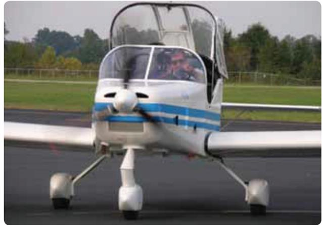
**Figura 13-13.** Estruturas de absorção de impacto feitas de aço, alumínio ou material composto transferem as forças do impacto da aterrissagem para a estrutura da aeronave a uma intensidade que não causa dano.
