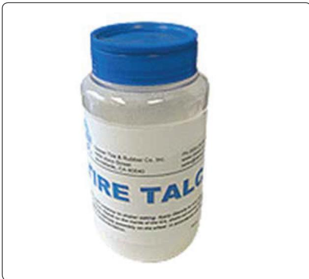
**Figura 13-155.** O talco de pneu é utilizado no interior de pneus do tipo câmara e do lado de fora das câmaras de aeronaves. Isto previne a ligação e permite que a câmara se expanda sem estresse no lugar dentro do pneu.
