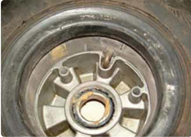
**Figura 13-157.** A montagem de um tipo de pneu de câmara com a haste da válvula de câmara posicionada para passar através da roda na metade da popa.
