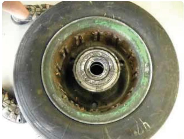
**Figura 13-60.** Chaves na metade interna da roda de aeronaves usadas para envolver e girar os rotores de um freio a disco
