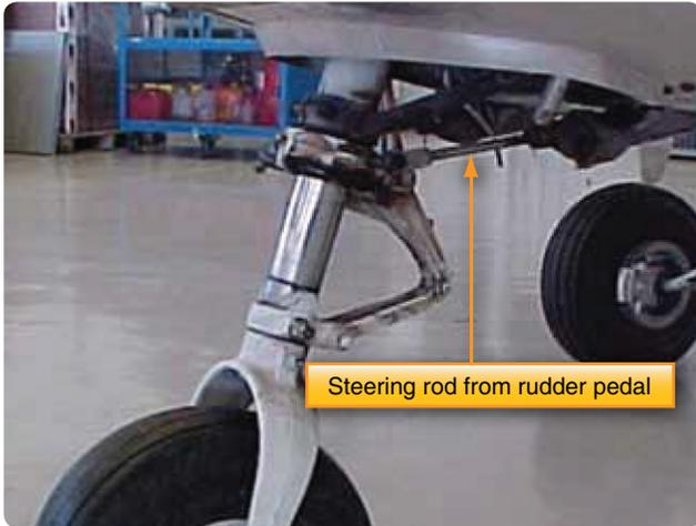
**Figura 13-50.** O direcionamento da roda do nariz em uma aeronave leve normalmente utiliza um sistema push-pull rod conectado a pedais de direcionamento do leme.
