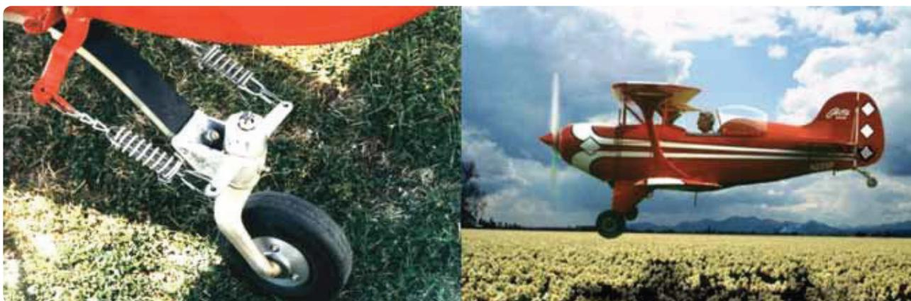
**Figura 13-4.** Roda da cauda dirigível de um Pitts Special.
