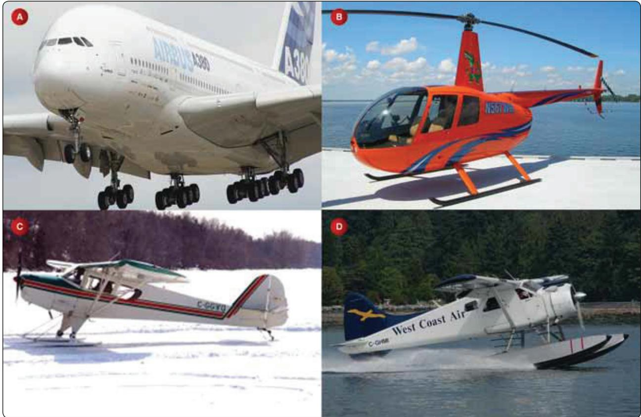
**Figura 13-1.** Tipos básicos de trem de pouso são os do tipo com rodas (a), esquis (b) (c) e flutuadores (d).
