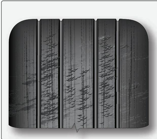
**Figura 13-142.** Cortes chavirão em um dos pneus são causados pela operação em superfícies da pista com ranhuras. Cortes chavirão rasos são permitidos nos pneus de aviões.
