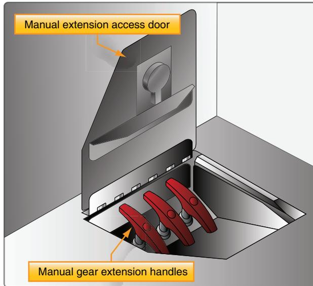
**Figura 13-38.** Essas alças de extensão de trem de pouso de emergência do Boeing 737 são localizadas embaixo de um painel no piso da cabine de comando. Cada alça libera uma trava via sistema de cabo para que o trem de pouso possa cair e estender-se.
