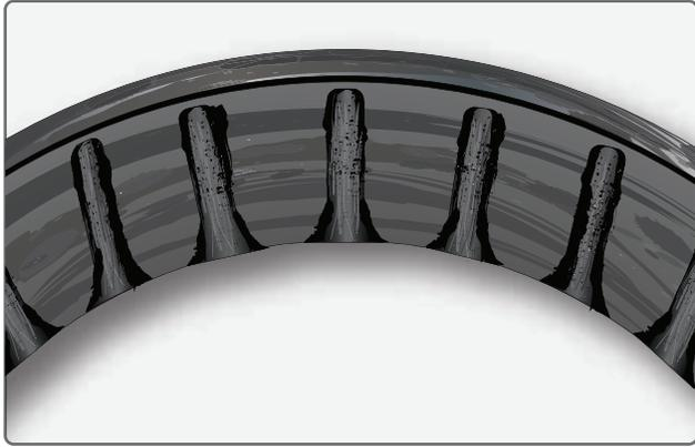
**Figura 13-69** Manchas e marcas na superfície localizada na capa do rolamento, são faixas pretas cinzentas com o mesmo espaçamento que os rolos e causado pela água que ficou dentro do rolamento. É a primeira fase de corrosão mais profunda que se segue.
