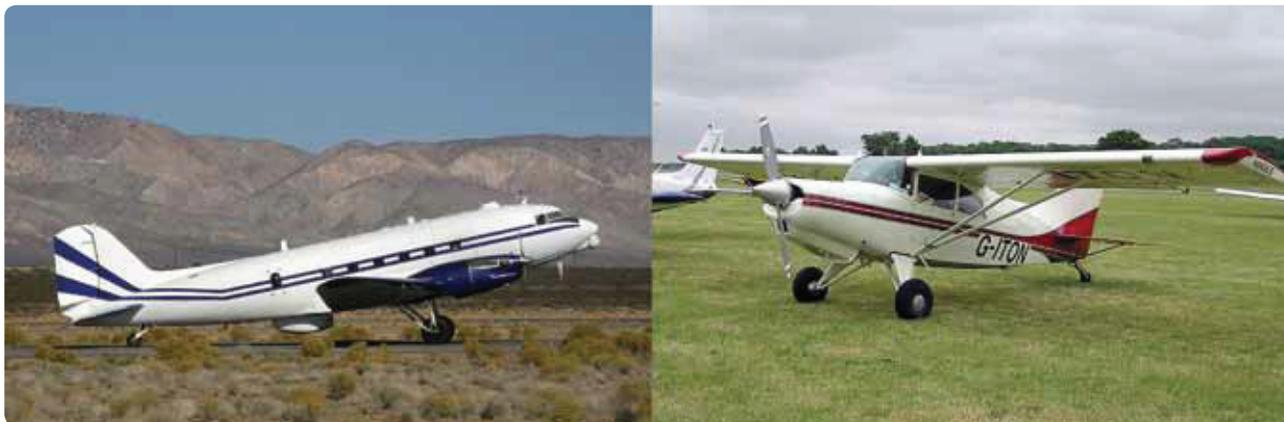
**Figura 13-3.** Configuração de trem de pouso tail wheel em um DC-3 (esquerda) e um STOL Maule MX 7-235 Super Rocket.
