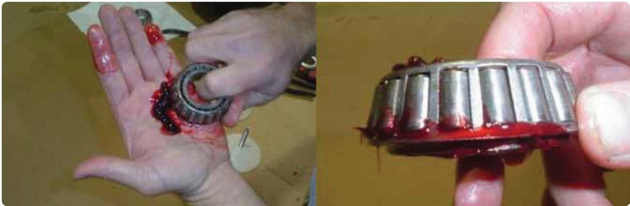
**Figura 13-45.** Colocar graxa em um rolamento limpo e seco pode ser feito sem uma ferramenta de aplicação de graxa. Pressione a peça sobre a graxa colocada na palma da mão até que ela passe totalmente pelos espaços entre as esferas e por todas as partes do rolamento.
