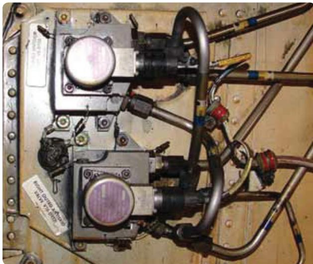
**Figura 13-111.** Duas válvulas de controle antiderrapante com encanamento e fiação associados.
