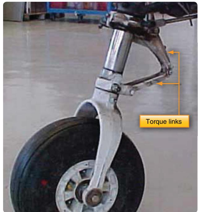
**Figura 13-19.** Torque links alinham o trem de pouso e retém o pistão no cilindro superior quando o amortecedor está estendido.
