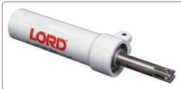
**Figura 13-56.** Shimmy damper não hidráulico utilizado como pistão de borracha com lubrificante que umedece a peça através do movimento contra o diâmetro interno da unidade.
