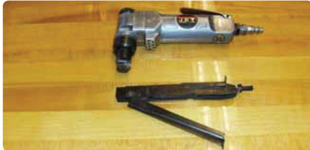
de no máximo 1/16 polegada de espessura. Excesso de força aplicada ao metal durante a operação de corte entope os DIES fazendo com que eles falhem ou que o motor superaqueça. O mercado tem disponível cortadores manuais ou elétricos.
