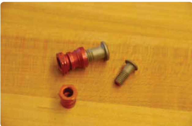
O colar Hi-Lok® de auto travamento rosqueado tem um rebaixo interno na base para acomodar variações da espessura do material. Na extremidade oposta do colar está um dispositivo de chave que é torcido pela ferramenta durante a instalação até que SHEAR OFF, assentando a porção inferior do colar com o torque correto sem inspeção adicional. Este ponto de SHEAR-OFF ocorre quando uma carga pré-determinada é alcançada durante a instalação.
