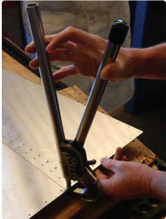
Punções de rebaixamento para trabalho leve podem ser usados em HAD SQUEEZERS pneumáticos portáteis. [Figura 4-93] Se os punções forem usados com um SQUEEZER eles devem ser ajustados para a espessura da chapa que está sendo rebaixada. Um rebitador de mesa é também utilizado para rebaixar materiais de revestimento finos e instalar rebites. [Figura 4-94]
