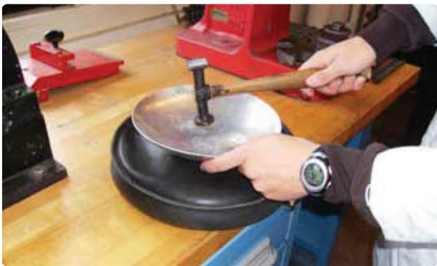
Abra o padrão e espalhe-o no metal no qual a peça será conformada. Embora o padrão não fique liso e plano ele dá uma ideia bem real do formato aproximado do metal que será cortado, e as seções recortadas indicam onde o metal será esticado. Quando o padrão tiver sido colocado sobre o metal risque na peça as
