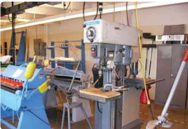
Quando utilizar uma furadeira de coluna a altura da mesa é ajustada para acomodar a altura da peça a ser furada. Quando a altura da peça for maior que a distância entre a broca e a mesa, esta deve ser baixada. Quando a altura da peça for menor que a distância entre a broca e a mesa, a mesa é levantada.
