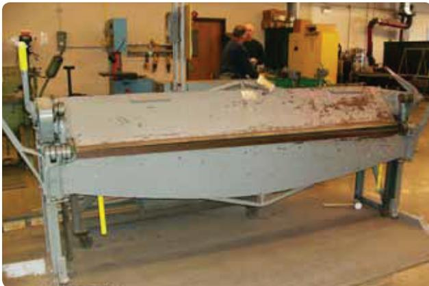
Para se fazer dobras simples com uma viradeira a chapa é colocada na BED com o SIGHT LINE (marca indicando a linha da dobra) diretamente abaixo da borda do CLAMPING BAR. A CLAMPING BAR é
