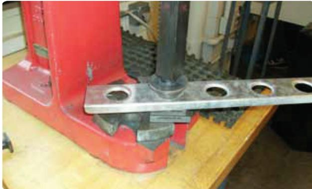
que o embutimento tiver sido formado os blocos de embutimento são virados na morsa e a protuberância no flange oposto é achatado com um macete de madeira ou couro cru. [Figura 4-164]
