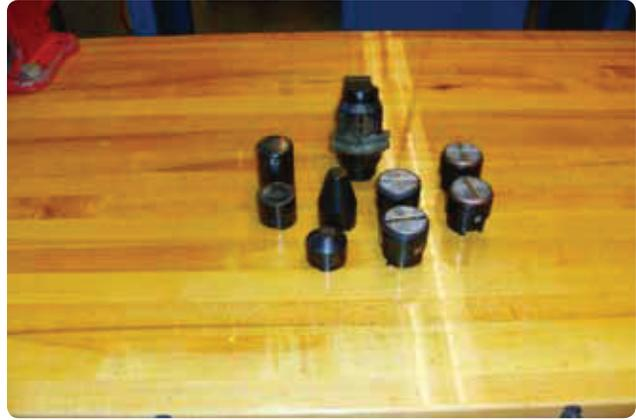
de metal. As ferramentas estão disponíveis com face em fibra de vidro (para não estragar a superfície) ou aço (para trabalhar com materiais mais duros) e são do tipo troca rápida.
