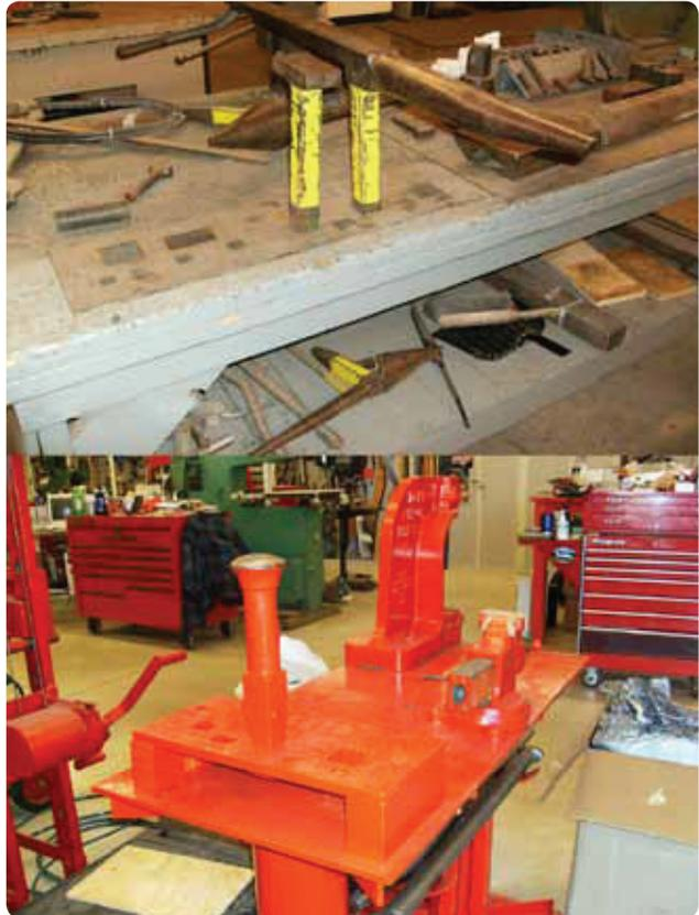
A maioria dos STAKES tem superfícies usinadas e polidas, que foram endurecidas. Os STAKES são utilizados com material de apoio quando se está es-carificando ou usando ferramentas de corte similares, para não danificar sua superfície e torná-lo inútil para o trabalho de acabamento.
