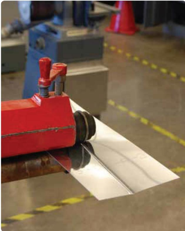
SKIN. Peças uniformemente CONTOURED produzidas rapidamente dão a STRETCH FORMING uma vantagem sobre as partes HAND FORMED. Além disso a condição do material é mais uniforme do que a obtida com HAND FORMING.
