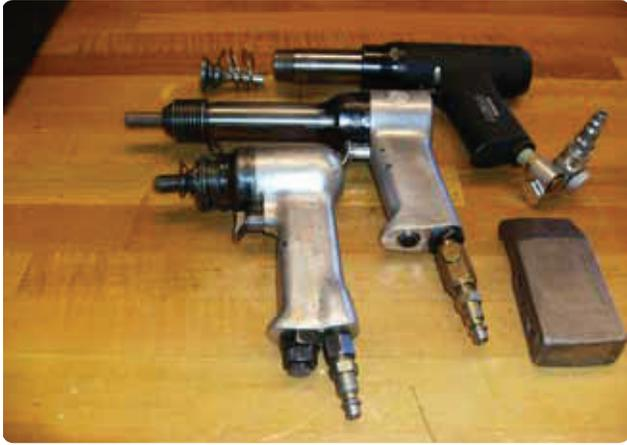
tes maiores em estruturas mais espessas. Um martetele deve instalar um rebite entre 1 e 3 segundos. Com prática, um técnico em manutenção de aeronaves aprende por quanto tempo precisa segurar o gatilho.
