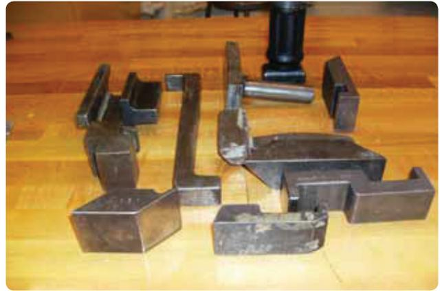
gura 4-83] Se a barra não tiver o formato correto a cabeça do rebite ficará deformada. Se a barra for leve demais, ela não derá o peso de apoio necessário, e o material poderá ficar saliente na direção da cabeça de oficina. Se a barra for pesada demais seu peso e a força de apoio podem fazer com que o material fique mais saliente do que a cabeça de oficina.
